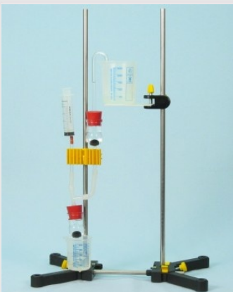
Configuración del ejercicio para investigar el modo de funcionamiento de las bombas
