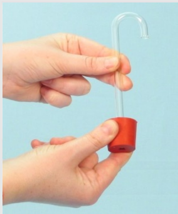
Inserte el tubo de vidrio en el tapón
